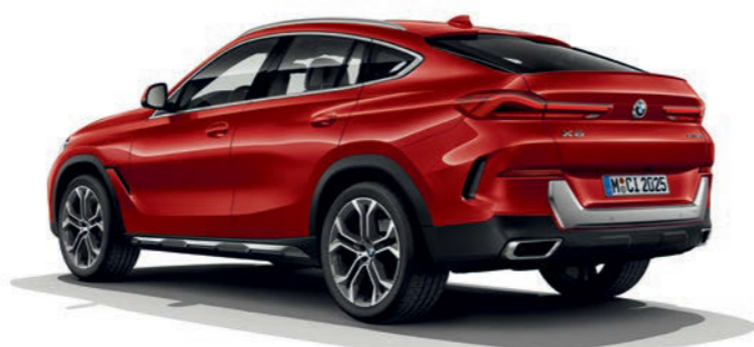
BMW X6 xDrive40i, Auspuffendrohre in Aluminium satiniert, optischer Unterfahrerschutz in Schwarz matt
