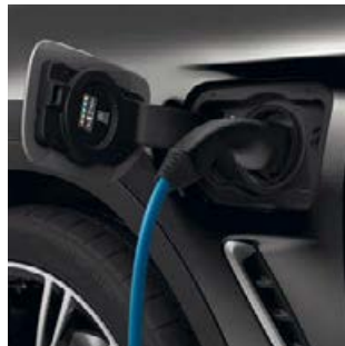
■ Hinter der Ladeklappe im vorderen linken Kotflügel verbirgt sich der Ladeanschluss der Plug-in-Hybrid-technologie inkl. Ladestatusanzeige.
